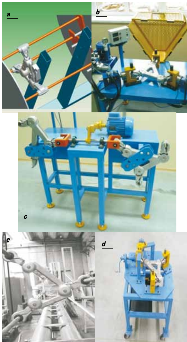
Rys. 3.2. Przykładowe badania odstępniaka tłumiącego produkcji Belos-PLP (a – drgania odcinkowe, b – symulacja prądów zwarciovych, c – drgania eolskie, d – próba elastyczności, e – próba wysiłgu zacisku po długotrwałym oddziaływaniu drgań eolskich)
