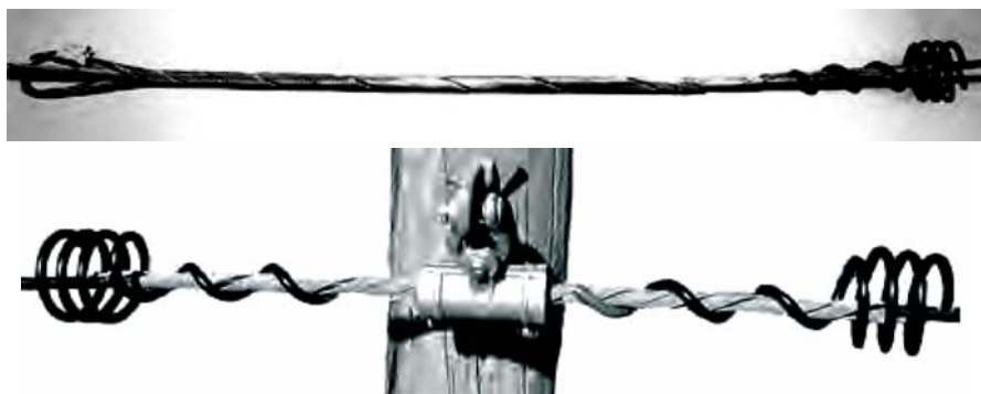
Rys. 9. Spirala Corona Coil we współpracy z uchwytem odciągowym i z zawieszem przelotowym (poniżej)
