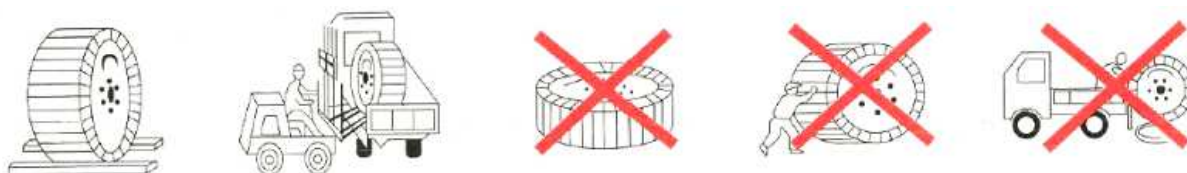
Rys. 1. Sposób przemieszczania bębna z przewodem OPGW
