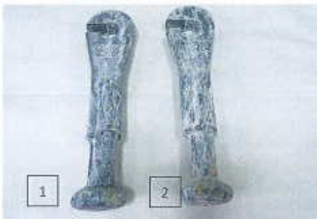
Rys. 10. Widok łączników po 500 h ekspozycji w obojętnej mgłę solnej – po umyciu
