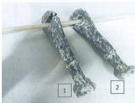
Rys. 8. Widok łączników po 300 h ekspozycji w komorze solnej – bez mycia
