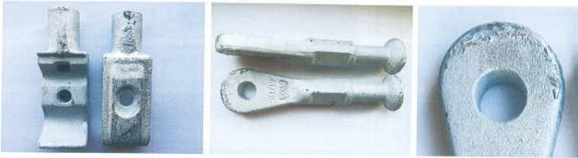
Rys. 1. Wady powłoki cynkowej identyfikowane po procesie cynkowania ogniowego z odwirowaniem [badania własne]
